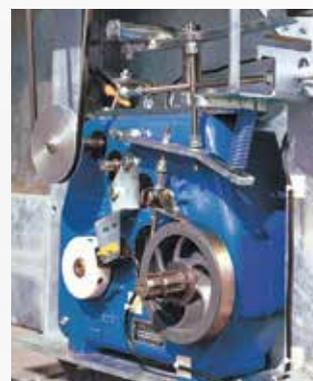
Boîte de vitesses de confort avec coulisse de changement de vitesse précise et indicateur de vitesse. Permet de changer la vitesse d'enroulement facilement et sans risque. Un système de sécurité du levier d'embrayage empêche le changement de vitesse quand l'entraînement est embrayé.
